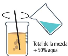
**E)** Finalmente se realiza un proceso de lavado y secado. Al total de la mezcla de biodiésel se agrega 50 % de agua y se revuelve intensamente. Como el agua es más pesada va hacia abajo arrastrando todas las impurezas o residuos que pudieran quedar. Otra vez en la ampolla de decantación se quita el agua y las impurezas.
