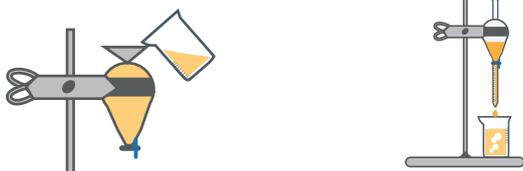
**C)** La mezcla se deposita en las ampollas de decantación y se deja reposar. Allí, el glicerol, junto con otros residuos del proceso, se asientan en el fondo. Mediante la llave de paso se quita el glicerol y demás residuos. Lo que queda es el biodiésel.
