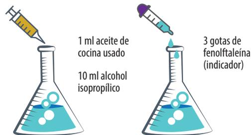
**B)** En un recipiente Erlenmeyer se coloca 1 ml del aceite de cocina usado a titular + 10 ml de alcohol isopropílico (para disolver el aceite). Luego, se agregan 3 gotas de fenolftaleína (indicador), porque reacciona cuando una solución cambia de pH ácido a básico. La solución en el recipiente tendrá un color blanco pardo.
