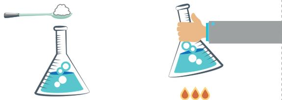
**A)** Se disuelve el hidróxido de sodio (NaOH) en metanol. Para lograr una mejor disolución se flamea (pasarlo sobre fuego para elevar suavemente su temperatura) con sumo cuidado porque el metanol es muy volátil y puede prenderse fuego fácilmente. Así se forma un metóxido de sodio.
