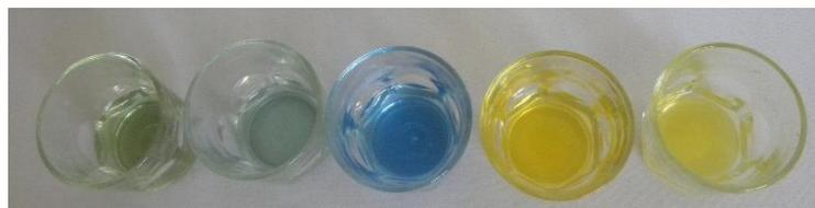
*¿Qué acidez tienen? Resultado del agregado de azul de bromotimol a (de izquierda a derecha): sal de mesa, azúcar, bicarbonato de sodio, vinagre, limón.*
