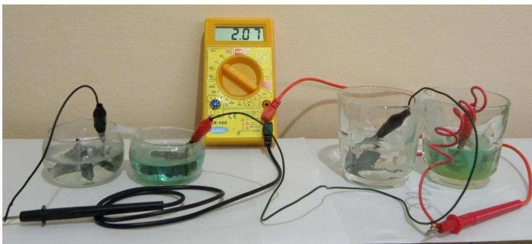
Medición de la diferencia de potencial de dos pilas en serie. El visor muestra la diferencia de potencial medida.
