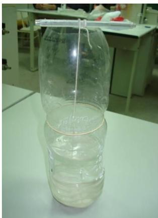
Figura 5. Dispositivo para crecimiento de cristales en suspensión
